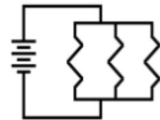
$$\frac{1}{R_p} = \frac{R_2 R_3 + R_1 R_3 + R_1 R_2}{R_1 R_2 R_3}$$
